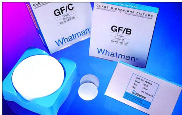
La capacidad de carga de un sistema de filtro puede aumentar de modo muy significativo usando un prefiltro. Los filtros GF/B o GF/D son ideales por su baja resistencia al flujo de fluidos y su alta capacidad de carga de partículas. El multigrado GMF 150 de Whatman es especialmente útil para la prefiltración de grandes volúmenes y soluciones que normalmente son difíciles de filtrar.
